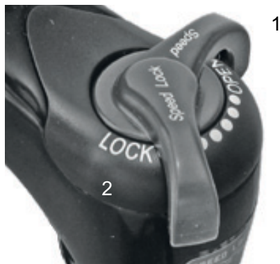
Abbildung 79: Suntour-Druckstufeneinsteller mit den Positionen OPEN (1) und LOCK (2)
