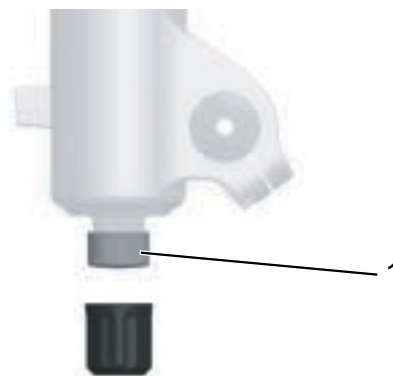
Abbildung 63: FOX-Zugstufeneinsteller (1) an der Gabel
