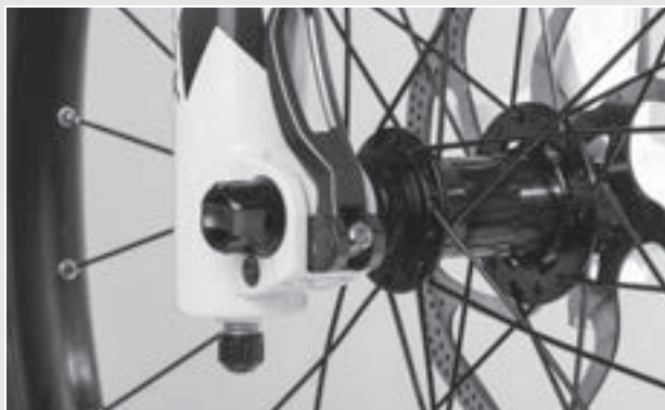
Abbildung 87: Spannkraft des Schnellspanners einstellen
