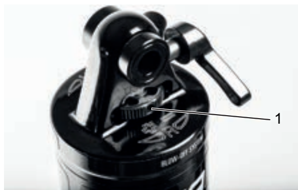
Abbildung 64: Suntour-Zugstufeneinsteller Rad(1) am Hinterbau-Dämpfer
