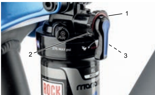
Abbildung 82: Härte des Zugstufen-Dämpfers am Einstellrad (1) des Hinterbau-Dämpfers einstellen
