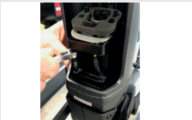
Paveikslėlis 23: 4 mm šešiabriaunių varžtų nuėmimas
