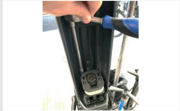
Paveikslėlis 24: Vidinių šešiabriaunių varžtų nuėmimas
