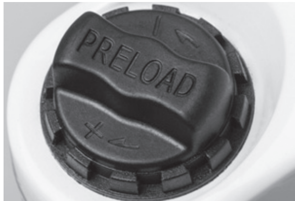
Paveikslėlis 55: Neigiamos amortizatorių eigos nustatymo ratukas ant amortizuojančių šakių karūnėlės
