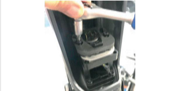
Paveikslėlis 22: Akumuliatoriaus laikiklio varžtų atsukimas
