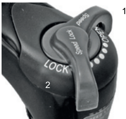
Paveikslėlis 64: „Suntour“ slėgio pakopų nustatymo reguliatorius su padėtimis OPEN (1) ir LOCK (2)
