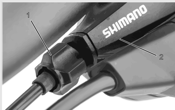
Paveikslėlis 69: Reguliavimo įvorė (1) vieno praėjimo kabeliu valdomam pavarų perjungimui su pavarų svirties korpusu (2), pavyzdys
