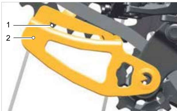
154. ábra: Ablakkivágás (1) fogakkal a Chain-Gap mérőidomban (2)
