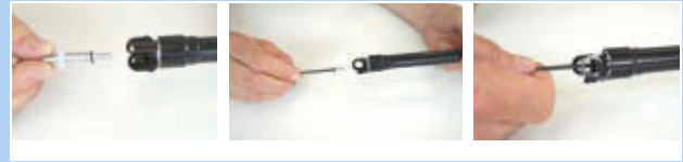
269. ábra: Tubus szelepfedél rögzítése
