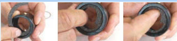
294. ábra: Filcgyűrű behelyezése
