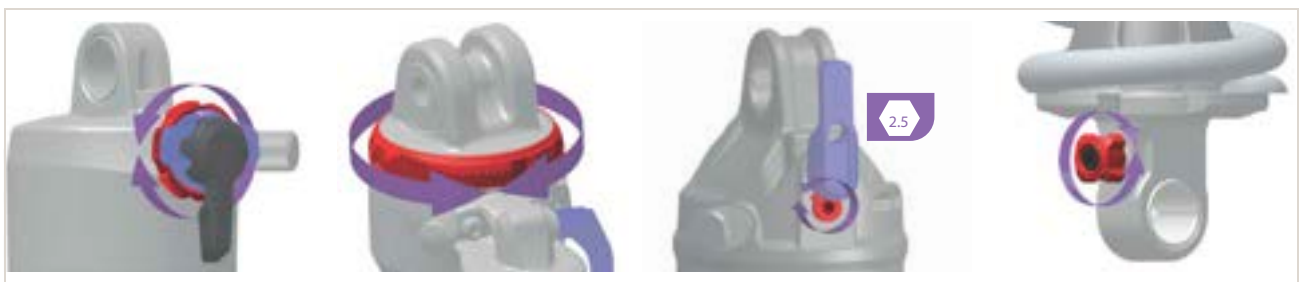
324. ábra: A húzófokozat-beállító (hátsó lengéscsillapító) (piros) elhelyezkedése és alakja a modelltől függ
