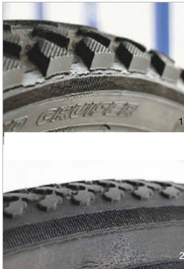
214. ábra: Példák kifáradási repedésekre (1) és öregedési repedésekre (2)
