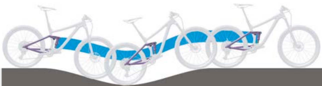
9. ábra: A hátsó lengéscsillapító optimális menetviselkedése dombos terepen
