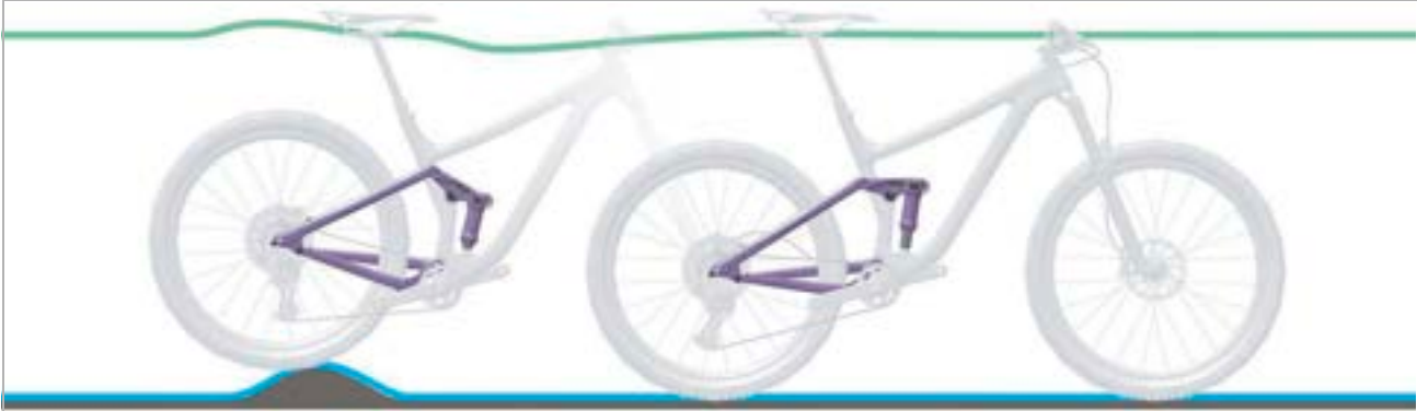
187. ábra: A hátsó lengéscsillapító optimális menetviselkedése egyenetlenségeknél
