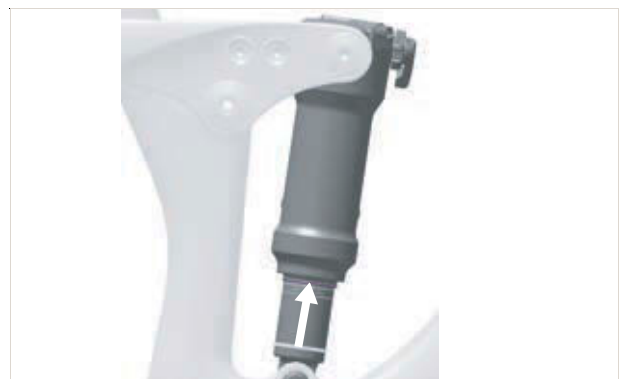
172. ábra: O-gyűrű eltolása a hátsó lengéscsillapítón
