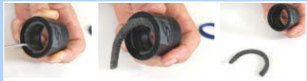
257. ábra: A filcgyűrű eltávolítása
