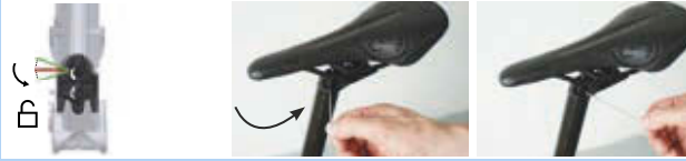
246. ábra: A magasságállító működtető beállítása „nyitott” állásba
