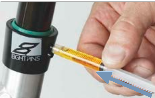
211. ábra: EIGHTPINS nyeregcső kenése
