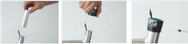
270. ábra: Siklópersely és külső hüvely beépítése
