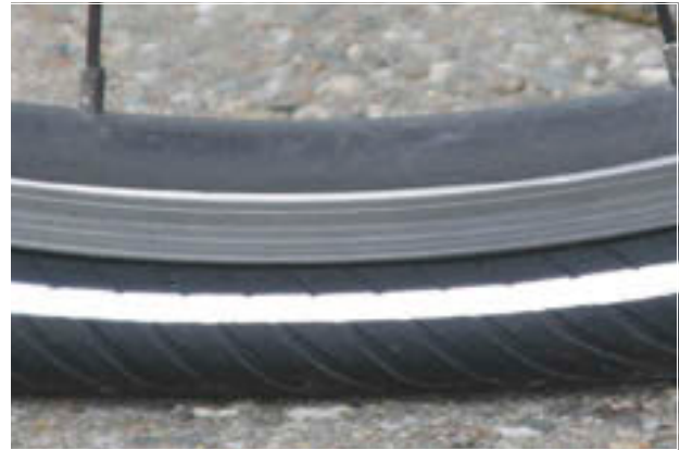
144. ábra: Túl alacsony töltőnyomás
