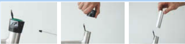
254. ábra: Külső hüvely és siklópersely kiszérése
