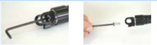
266. ábra: Szelepszapka kicsavarozása
