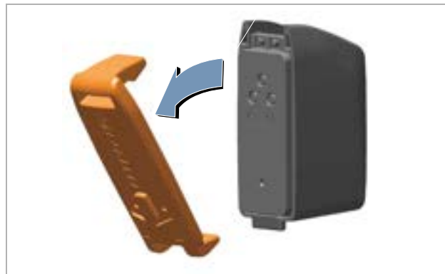
347. ábra: Az akkumulátorfedél eltávolítása
