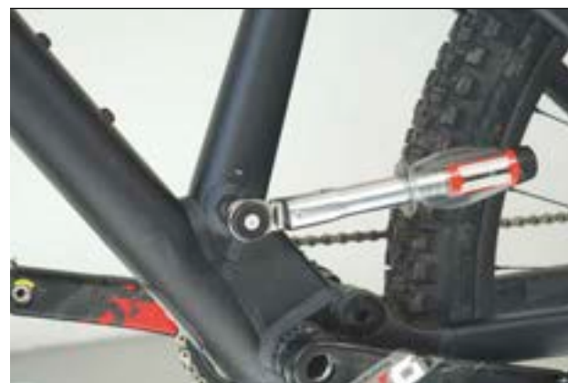
118. ábra: A nyeregcsőtengely meghúzása
