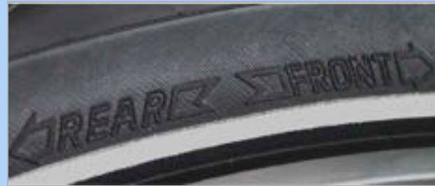
87. ábra: Futásirányjelző nyíl MTB gumiabroncsokon
