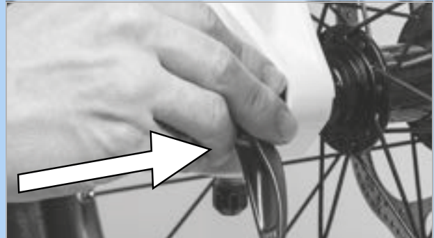
100. ábra: A gyorsár betolása nyírlirányban
