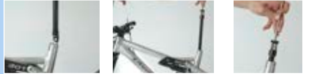
274. ábra: Tubus szelepfedél rögzítése
