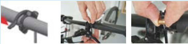
248. ábra: Tubus kiszérése
