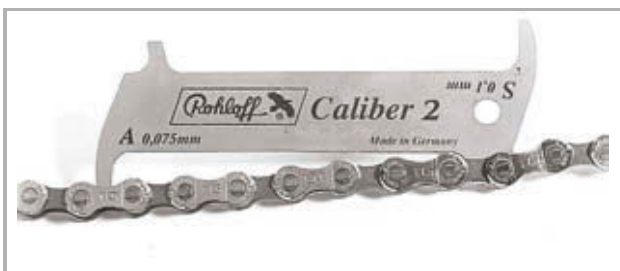
220. ábra: ROHLOFF mérőidom példája
