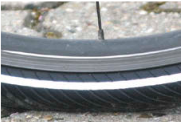
143. ábra: Helyes töltőnyomás. A gumibroncs alakja a testsúly terhe alatt alig változik
