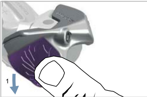
165. ábra: A váltófül lefelé nyomása
