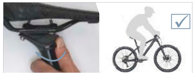
124. ábra: A nyeregcsőtengely meghúzása
