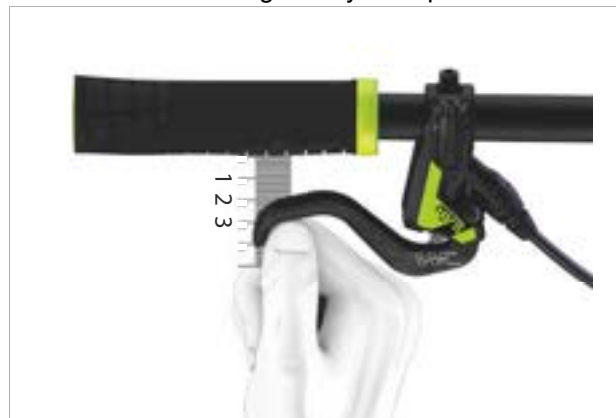
148. ábra: Kézifék pozicionálása
