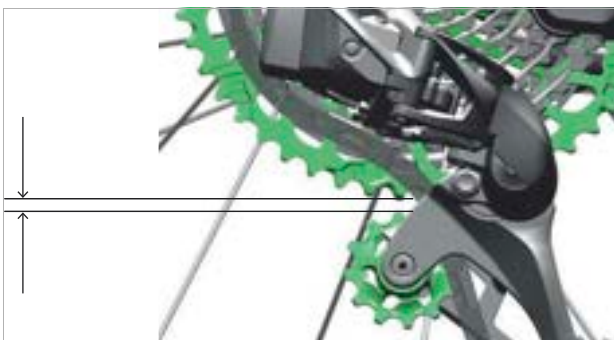
159. ábra: 3 mm távolság a terelőgörgő és a fogak között
