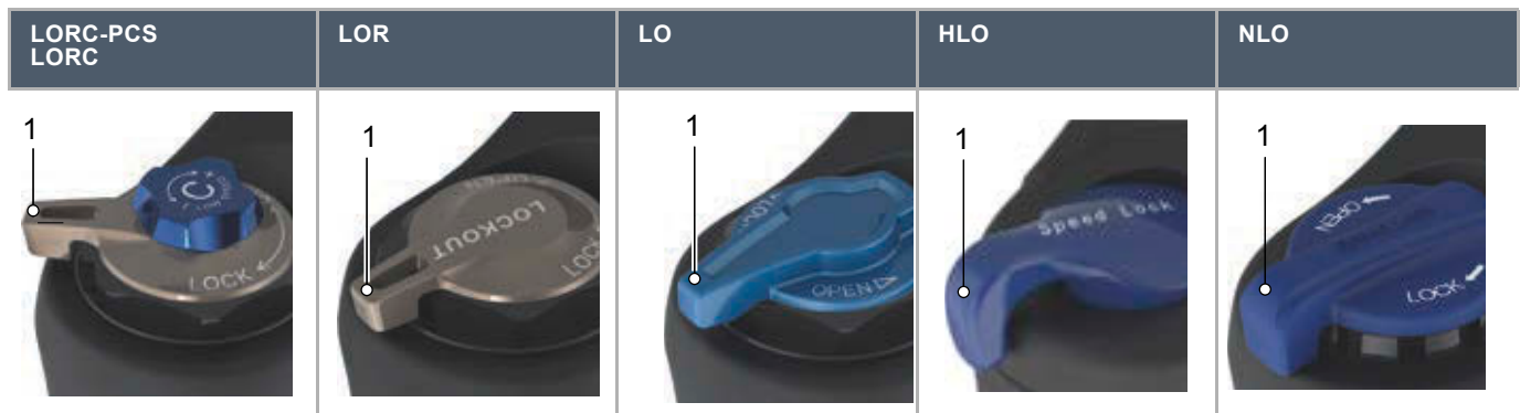
57. táblázat: SR Suntour teleszkópos villa zár a villakoronán
