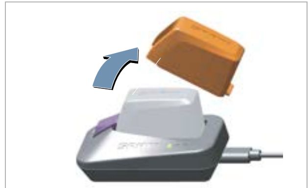
350. ábra: Az akkumulátorfedél eltávolítása
