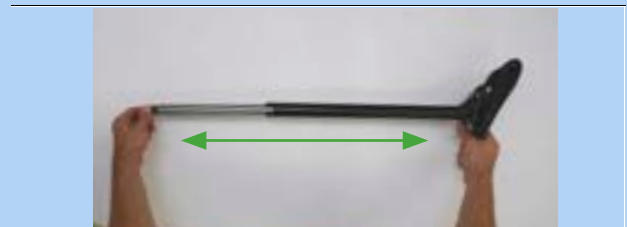
298. ábra: Nyeregcső széthúzása
