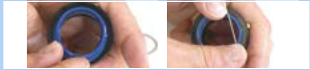
295. ábra: A lehúzó behelyezése és rögzítése
