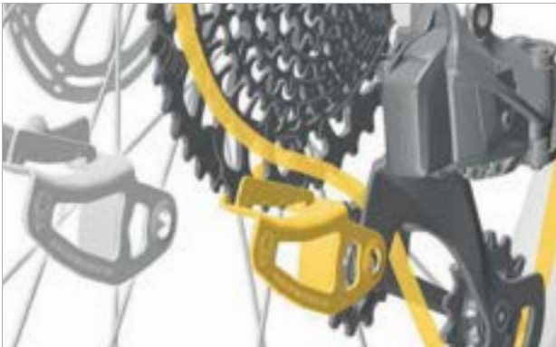
153. ábra: A lánc második legnagyobb fogaskoszorún van
