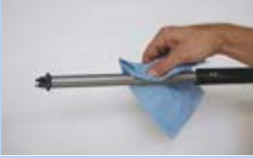
299. ábra: Hosszirányú vezetőhorony tisztítása
