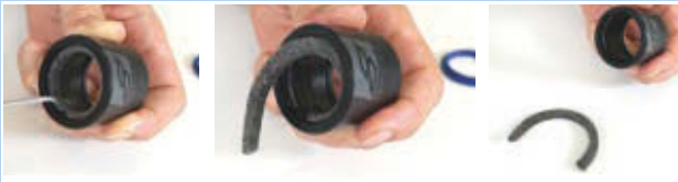
292. ábra: A filcgyűrű eltávolítása
