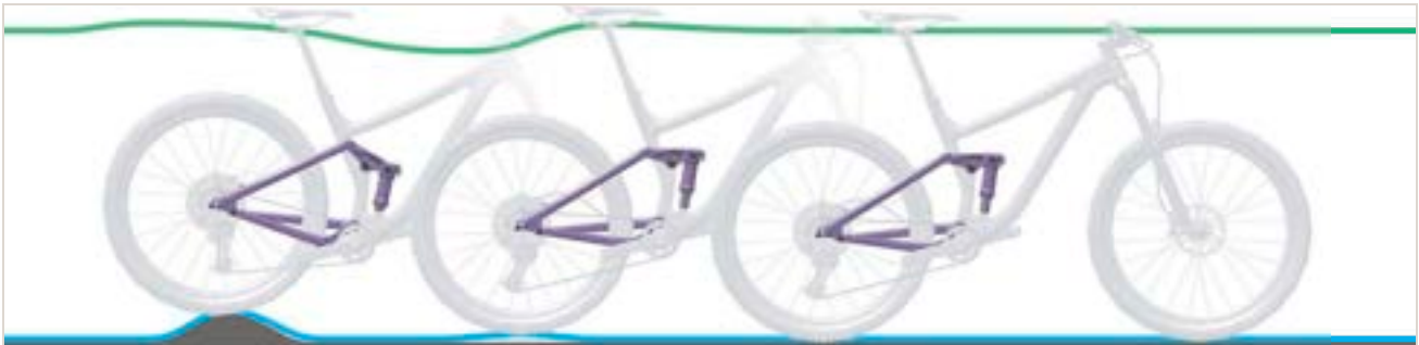
323. ábra: A hátsó lengéscsillapító túl gyors kirugózása
