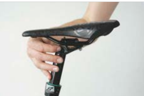
131. ábra: Nyereg dőlésszögének beállítása a beállító kerékkel
