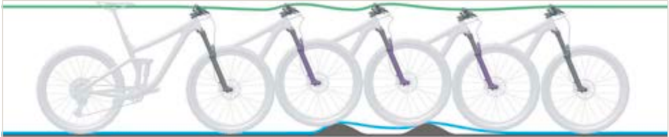
311. ábra: A teleszkópos villa túl lassú kirugózása
