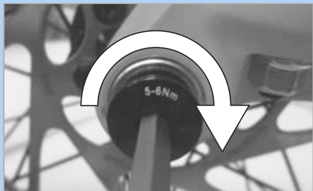
92. ábra: A rögzítőcsavar meghúzása
