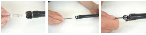
265. ábra: Tubus szelepfedél rögzítése
