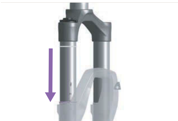
168. ábra: A teleszkópos villa O-gyűrűjének eltolása
