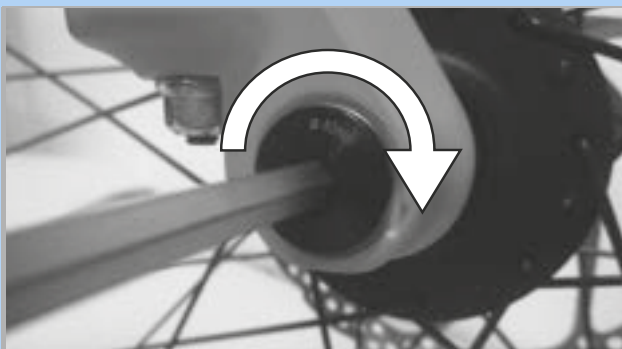
90. ábra: A tengely meghúzása nyílrányban
