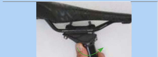
297. ábra: Magasságállítás nyitása
