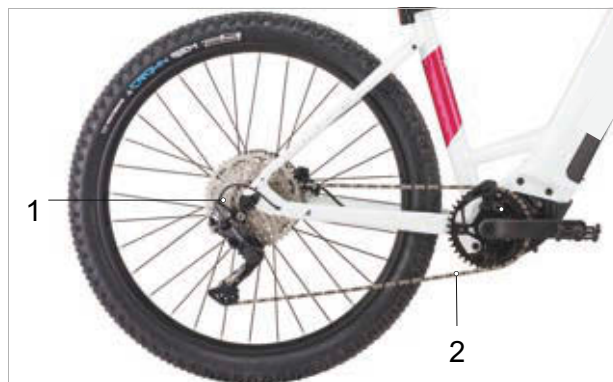
50. ábra: Külső váltóval felszerelt lánchajtás vázlata
