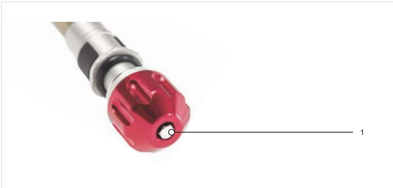
175. ábra: Példa: SR SUNTOUR húzófokozat-beállító (teleszkópos villa) (1)
