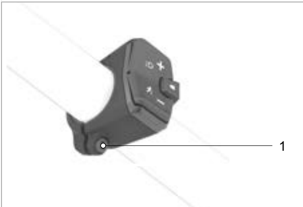
340. ábra: A rögzítőcsavar elhelyezkedése
