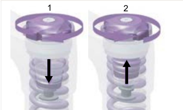
167. ábra: A SAG beállító kerék be- (1) és kitekerése (2)
