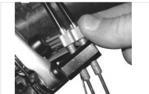
239. ábra: Belső váltóvezérléssel rendelkező ROHLOFF agyváltozatok húzásbeállítója a húzásellentartón van
