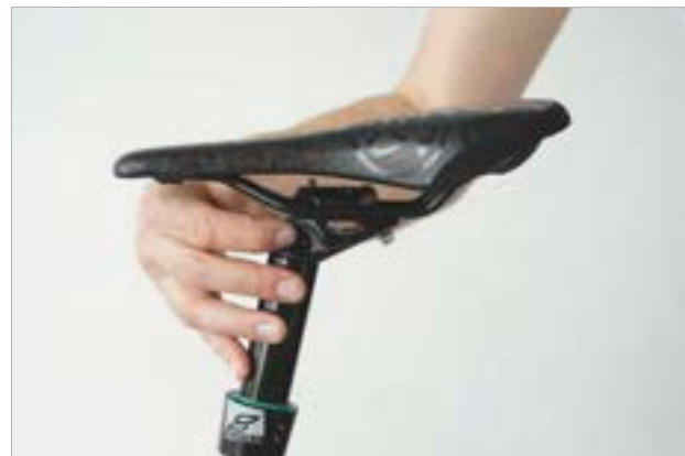
133. ábra: Nyereg dőlésszögének beállítása a beállító kerékkel
