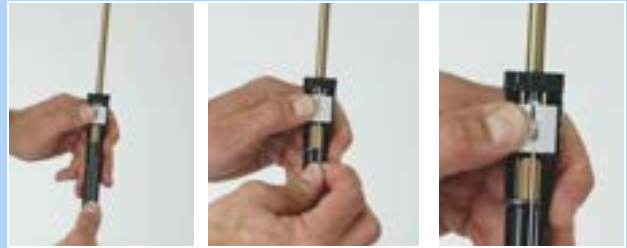
251. ábra: A bovdent kiakasztása
