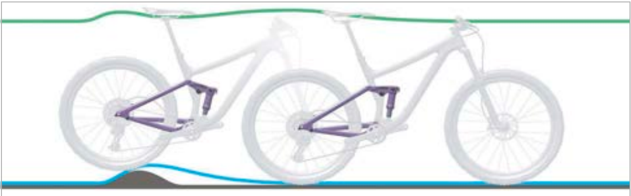
337. ábra: A hátsó lengéscsillapító túl kemény csillapítása egyenetlenségeknél
