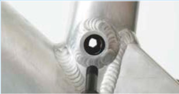
306. ábra: A Postpin csatlakozás nyílása
