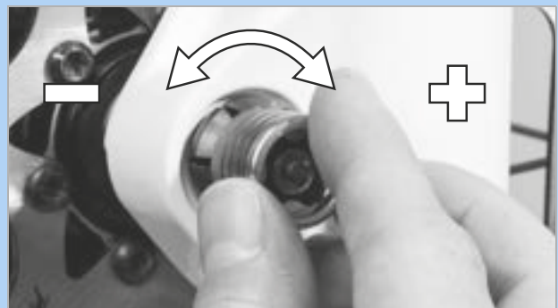
101. ábra: A feszítés beállítása
