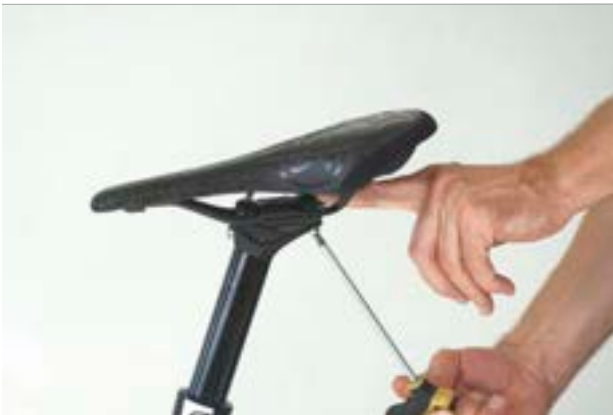
127. ábra: Hátsó csavar meglazítása
