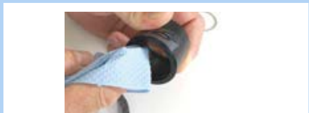
258. ábra: Külső hüvely tisztítása
