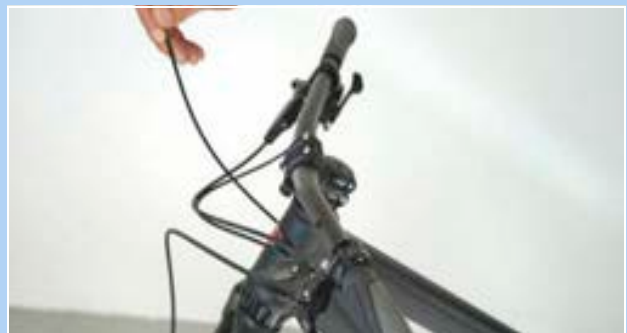
305. ábra: Végsapka beakasztása
