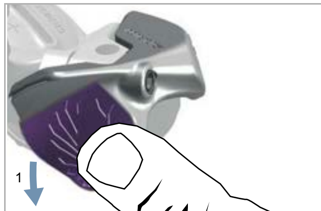
160. ábra: A váltófül lefelé nyomása
