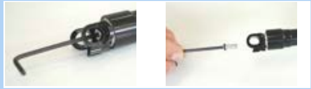
262. ábra: Szelepsapka kicsavarozása
