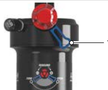
55. táblázat: Nyomásfokozat-kar (hátsó lengéscsillapító) (1) az EDGE Plus 2CR hátsó lengéscsillapítón
