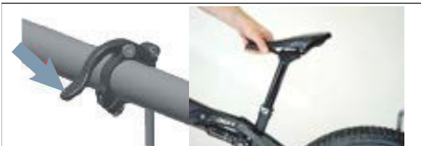
122. ábra: Hidraulikus gázrugó kiengedése
