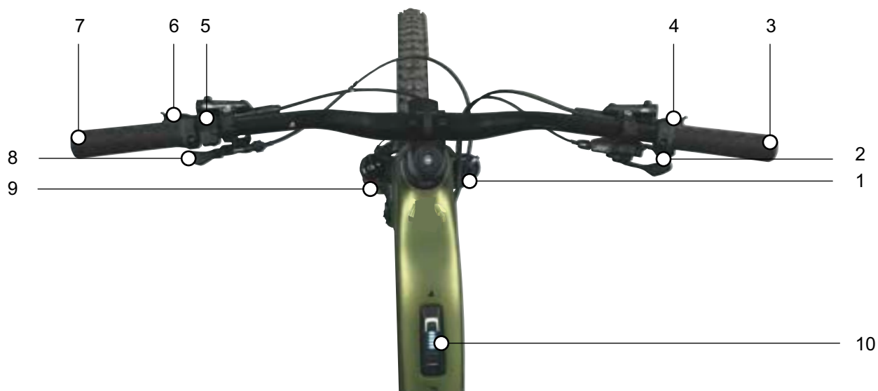
60. ábra: Kormány Bosch rendszervezérlő fedélzeti számítógéppel és Mini Remote kezelőegységgel részletes nézet, példa
