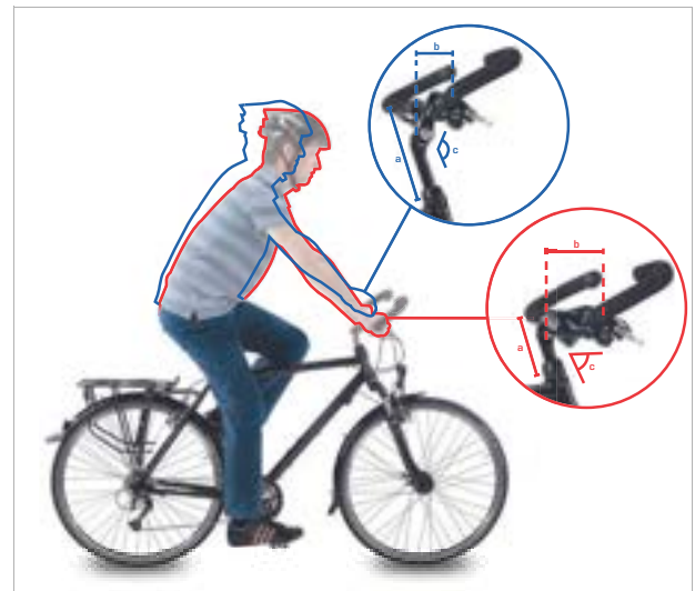
141. ábra: Városi kerékpár (kék) és túrakerékpár (piros) a szög változtatásával
