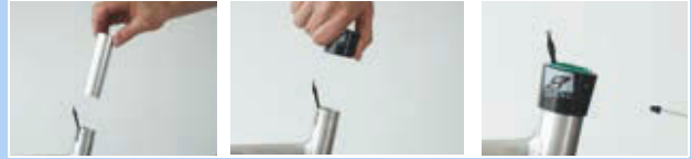
303. ábra: Siklópersely és külső hüvely beépítése
