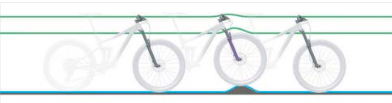
204. ábra: Keményre és puhára beállított nyomásfokozatos lengéscsillapító
