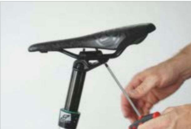
130. ábra: Hátsó csavar meglazítása
