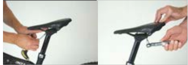
129. ábra: Első és hátsó csavar rögzítése
