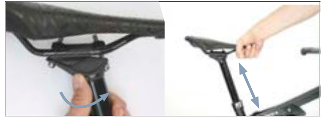
123. ábra: A nyeregcső magasságának beállítása
