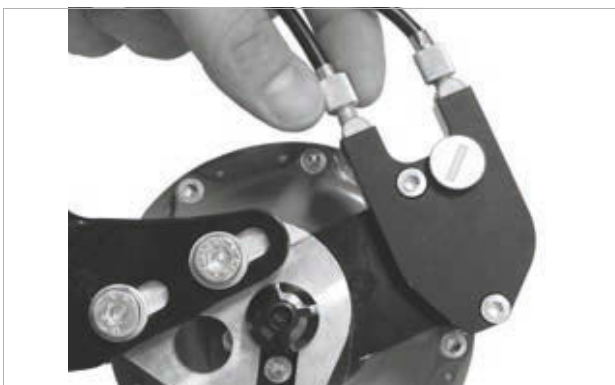
240. ábra: Külső váltóvezérléssel rendelkező ROHLOFF agyváltozatok húzásbeállítója a kötéldobozon van, ami a bal oldalon található
