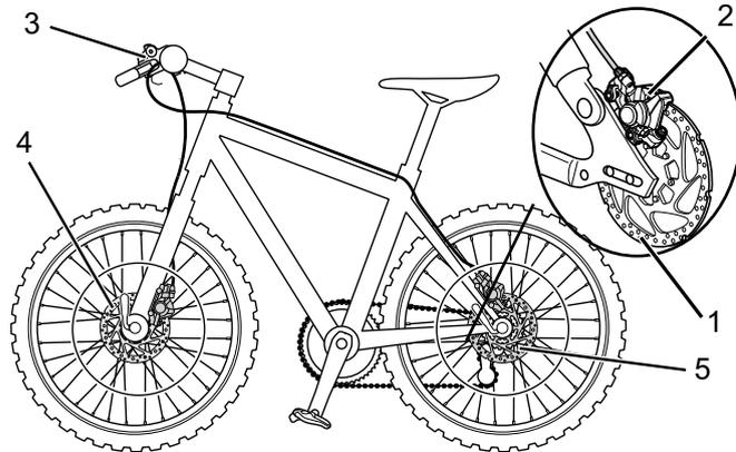
Abbildung 6: Bremssystem eines Fahrrads mit einer Scheibenbremse, Beispiel
