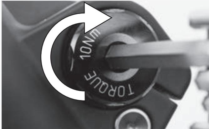
**Abbildung 16:****Eingesetzte Achse festdrücken**
