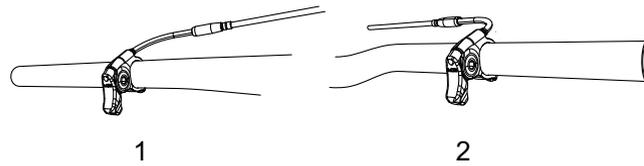
**Abbildung 32:** Der Betätigungshebel der Sattelstütze kann entweder links (1) oder rechts (2) am Lenker montiert sein.
