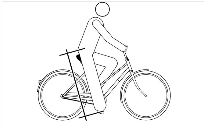
Abbildung 29: Optimale Sattelhöhe
