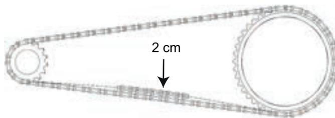
Abbildung 44: Kettenspannung prüfen
