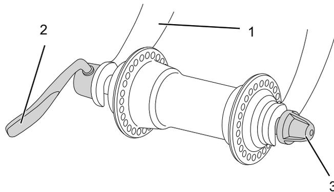
Abbildung 45: Laufrad Schnellspanner, Ausführung I, mit Spannhebel (2), Gabel (1) und Stellmutter (3)
