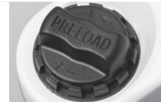
Abbildung 39: Einstellrad des Negativen Federwegs auf der Krone der Federgabel
