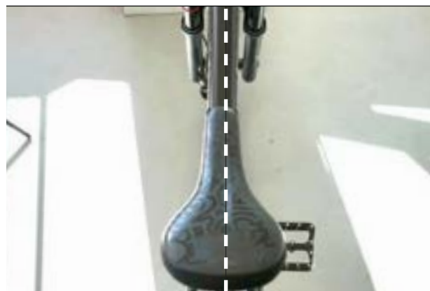
Slika 99: Centriranje sjedala u smjeru vožnje
