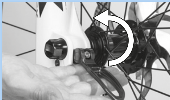
Slika 72: Pritisnite polugu brzog zatvarača u smjeru strelice
