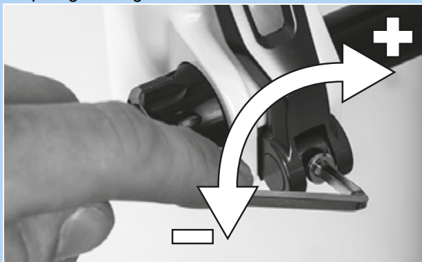
Slika 194: Podešavanje sile stezanja brzog zatvarača
