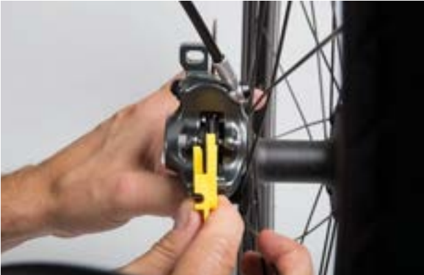
Slika 164: Provjera kočne pločice u ugrađenom stanju uz pomoć zaštite za transport
