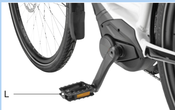
Slika 85: L-pedala u lijevoj poluzi
