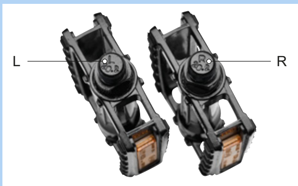
Slika 84: Primjer oznaka na pedalama
