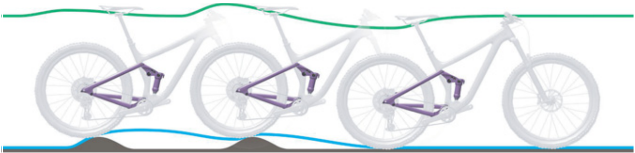
Slika 223: Presporo odskakivanje stražnjeg amortizera
