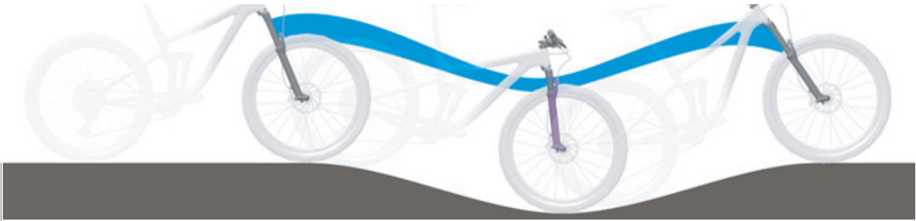
Slika 201: Premekan ovjes suspenzijske vilice na uzbrdici
