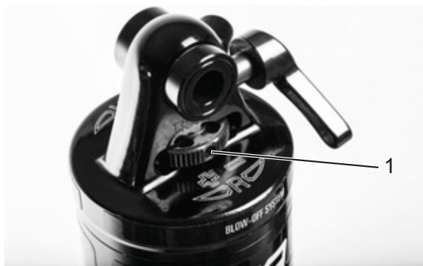
Slika 214: Kotačić za podešavanje odskoka SR SUNTOUR (1) na stražnjem amortizeru
