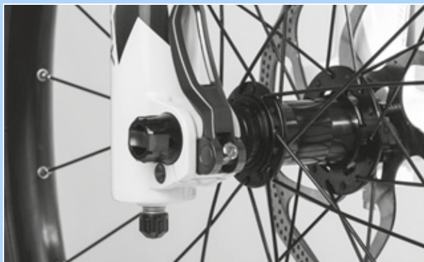
Slika 193: Podešavanje sile stezanja brzog zatvarača
