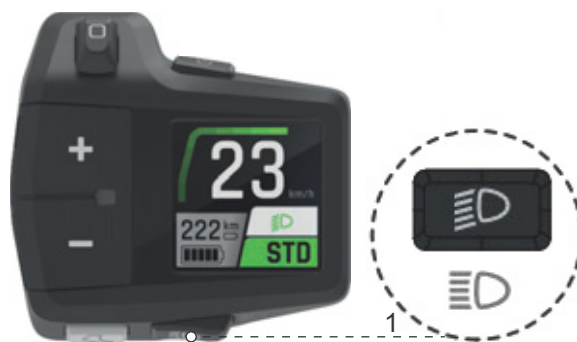
Slika 147: Položaj tipke za svjetlo
