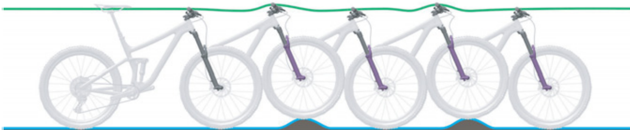
Slika 12: Optimalno ponašanje vilice pri vožnji
