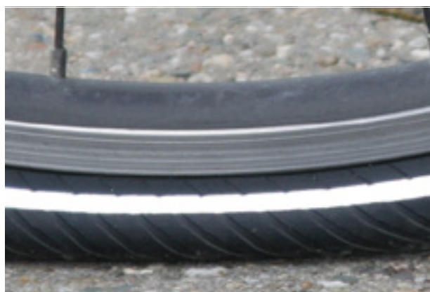
Slika 117: Prenizak tlak u gumama
