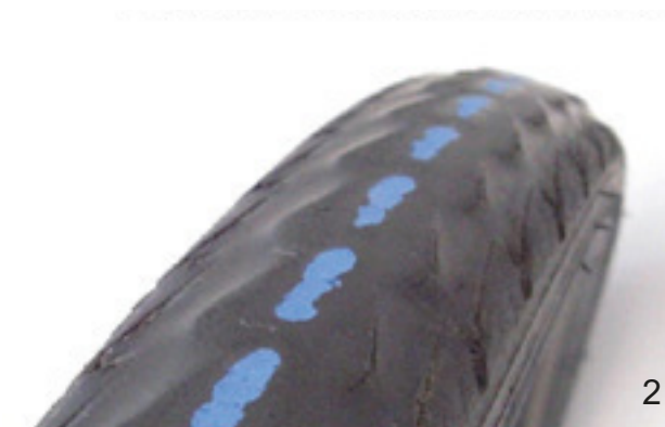
Slika 162: Guma bez profila koja se već može zamijeniti (1) i guma s vidljivom zaštitom od bušenja (2) koje se već mora zamijeniti.
