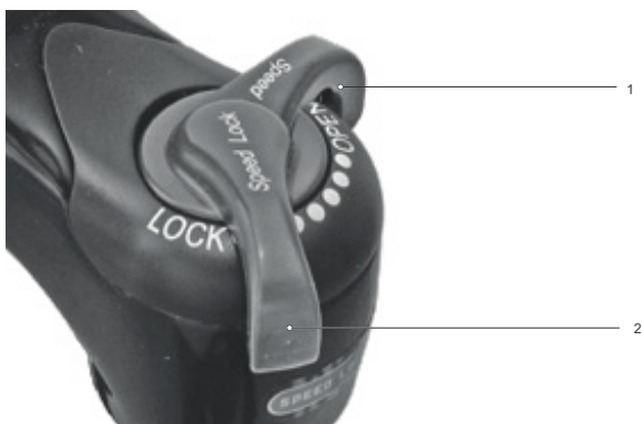
Slika 204: Smanjenje krutosti kotačićem za podešavanje kompresije
