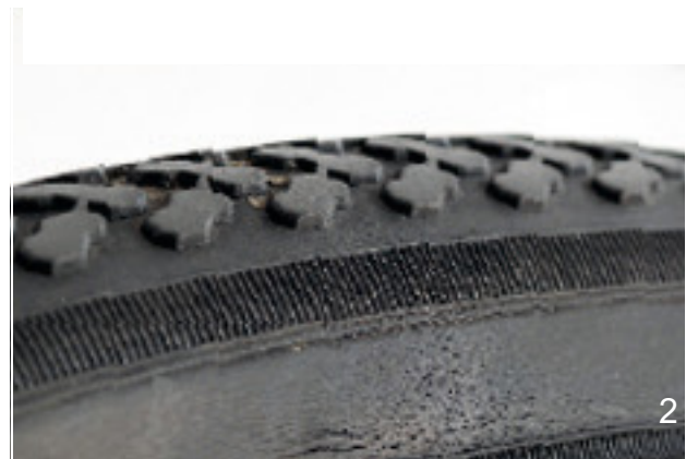
Slika 163: Primjeri pukotina uslijed zamora (1) i pukotina uslijed starenja (2)
