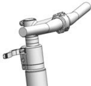
Slika 155: All Up s otvorenom steznom polugom lule
