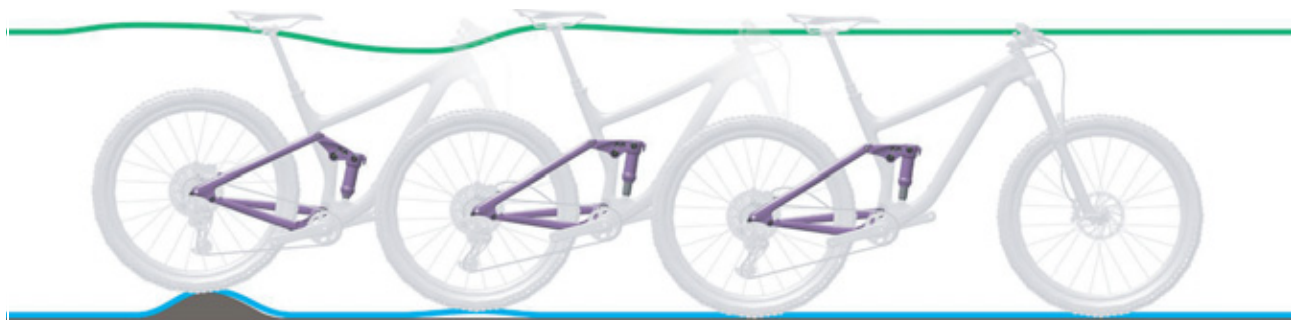
Slika 213: Prebrzo odskakivanje stražnjeg amortizera
