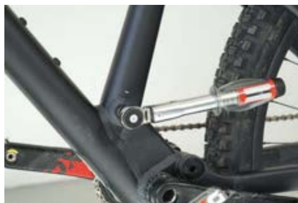
Slika 100: Pritezanje osovine cijevi sjedala
