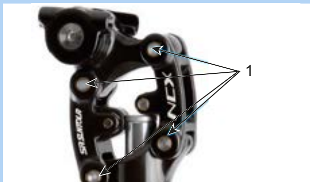
Slika 195: Točke podmazivanja amortizacijske cijevi sjedala SR SUNTOUR
