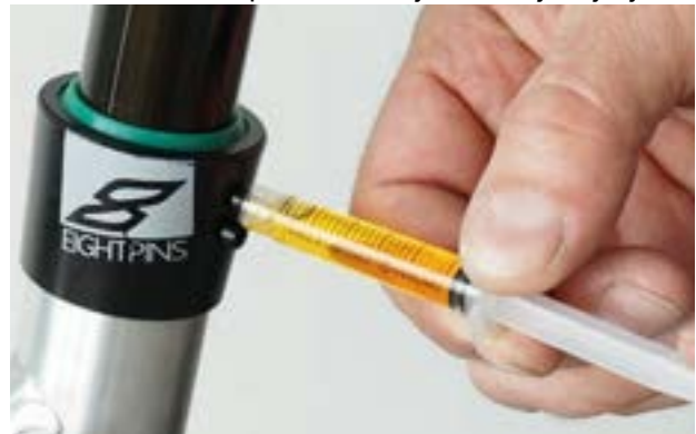
Slika 160: Podmazivanje eightpins cijevi sjedala
