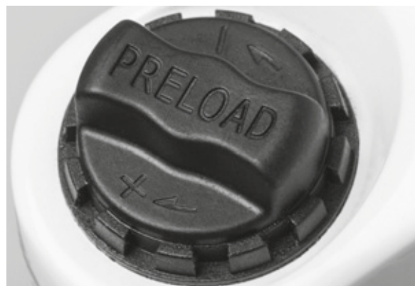
Figura 29: Manopola di regolazione dell'escursione negativa della sospensione sulla corona della forcella ammortizzata
