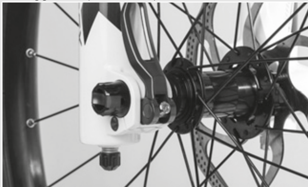
Figura 39: Regolazione della forza di serraggio del bloccaggio rapido
