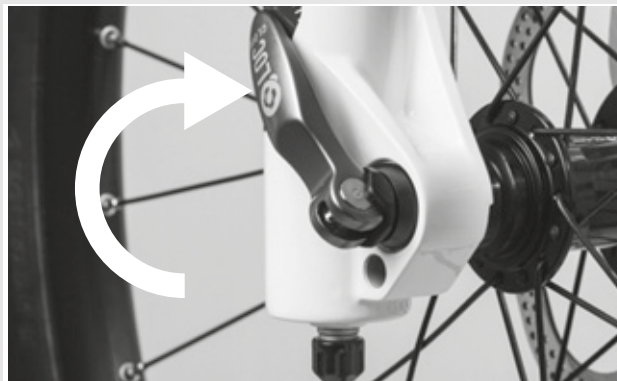
Figura 21: Chiusura del bloccaggio rapido
