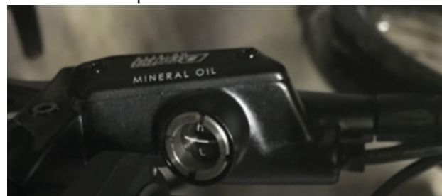
Figura 6: Finestrella di controllo del livello dell'olio
