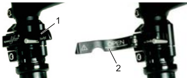
Figura 27: Leva di serraggio dell'attacco manubrio chiusa (1) e aperta (2), esempio by.schulz speedlifter
