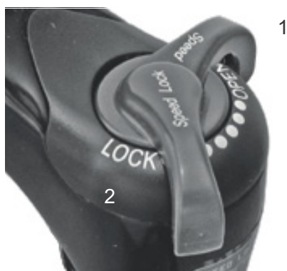
Figura 36: Regolatore dello stadio di pressione Suntour con posizioni OPEN (1) e LOCK (2)
