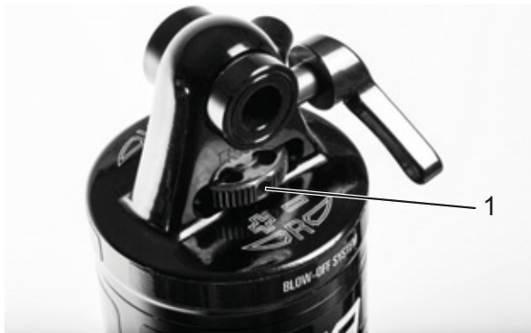
Figura 56: Regolatore del rebound Suntour (1) sull'ammortizzatore del carro posteriore
