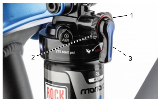
Figura 70: Regolazione della rigidità dell'ammortizzatore a stadi di trazione con la manopola di regolazione (1) dell'ammortizzatore del carro posteriore
