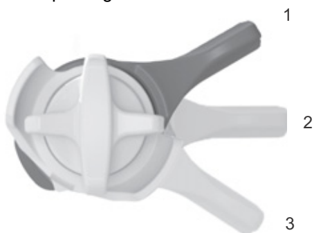
Figura 65: Regolatore della compressione FOX sull'ammortizzatore del carro posteriore con le posizioni APERTO (1), MEDIO (2) e RIGIDO (3)
