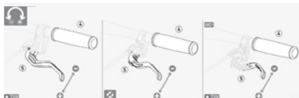
Figura 50: Regolazione dell'ampiezza di presa della leva del freno Magura con freno a disco
