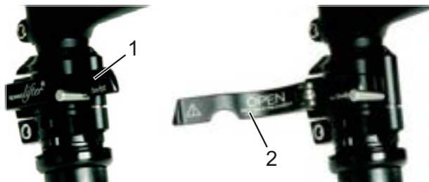
Figura 46: Leva di serraggio dell'attacco manubrio chiusa (1) e aperta (2), esempio by.schulz speedlifter
