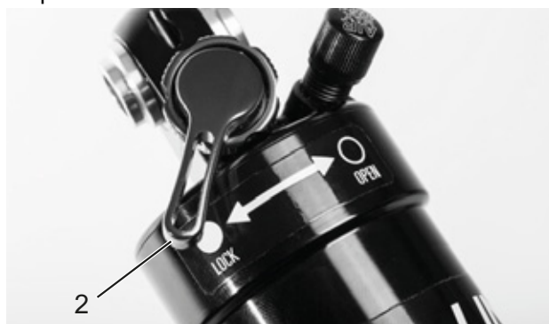
Figura 69: Regolatore della compressione Suntour chiuso (2)
