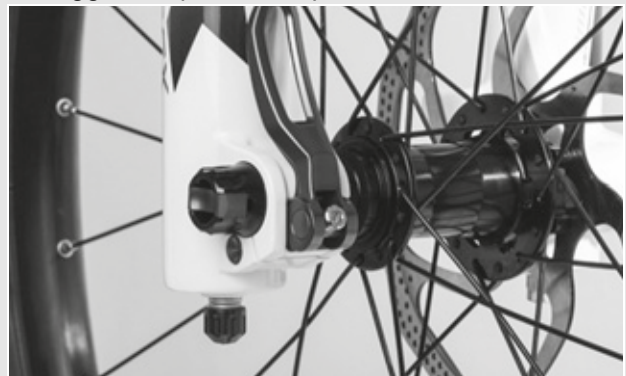
Figura 75: Regolazione della forza di serraggio del bloccaggio rapido
