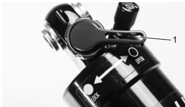
Figura 68: Regolatore della compressione Suntour aperto (1)
