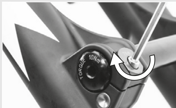
Figura 25: Serraggio del morsetto di sicurezza
