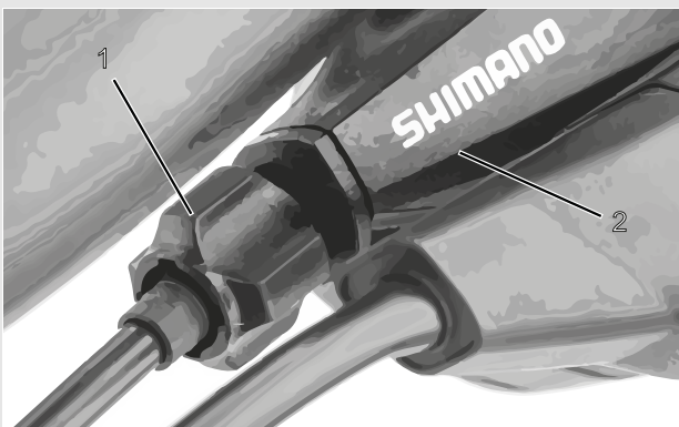
Figura 77: Boccola di regolazione (1) del cambio azionato da cavo singolo con scatola della leva del cambio (2), esempio
