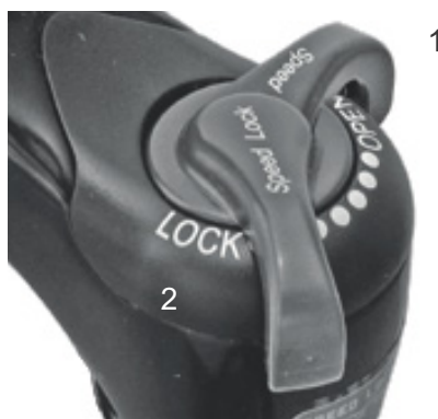
Figura 67: Regolatore della compressione Suntour con posizioni OPEN (1) e LOCK (2)
