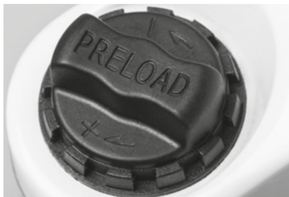
Figura 52: Manopola di regolazione dell'escursione negativa della sospensione sulla corona della forcella ammortizzata
