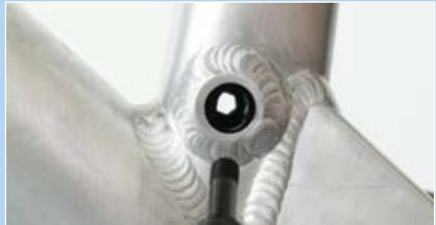
Illustration 209 : Trou de l'interface Postpin
