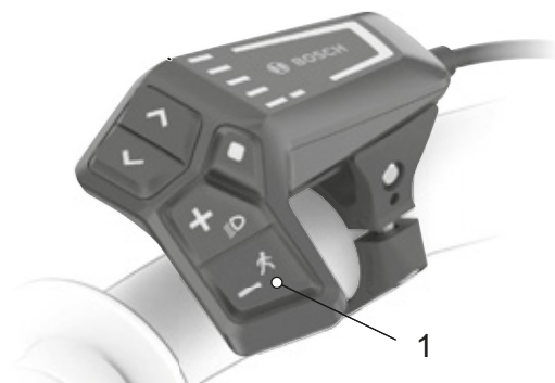
Illustration 124 : Position de la touche d'assistance de poussée (1)
