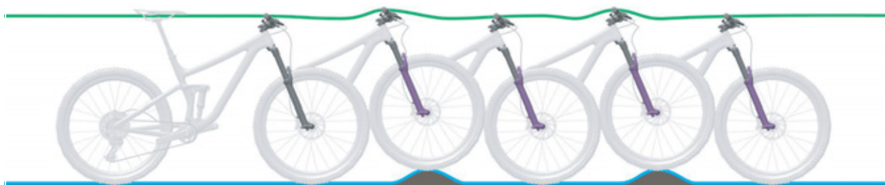
Illustration 98 : Comportement optimal de la fourche
