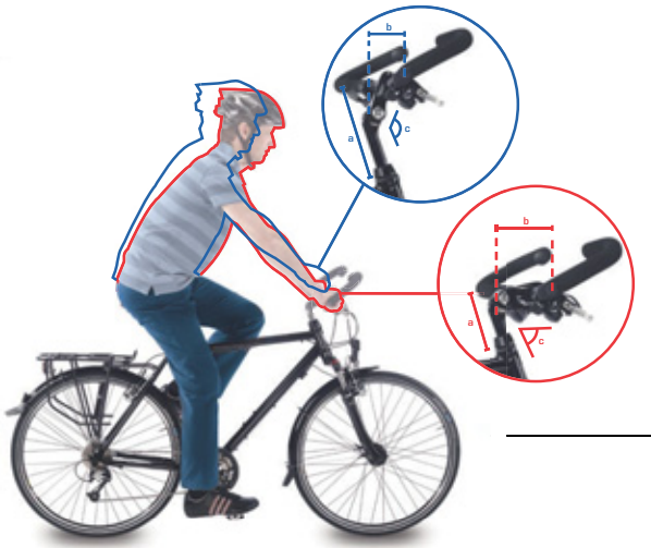
Illustration 85 : Position sur vélo de ville (en bleu) et sur vélo tout chemin (en rouge) avec modification de l'angle
