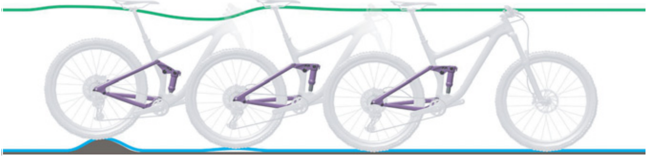
Illustration 219 : Détente trop rapide de l'amortisseur arrière
