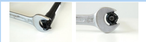
Illustration 170 : Empêcher l'interface de montage de tourner
