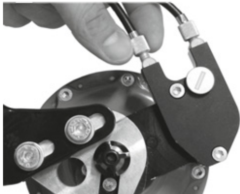
Illustration 142 : Sur les versions de moyeux ROHLOFF avec commande externe du changement de vitesse, le dispositif de réglage de la tension est situé sur le boîtier de câbles qui est placé sur le côté gauche.
