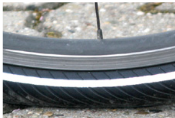
Illustration 87 : Pression correcte. Le pneu se déforme à peine sous le poids du corps
