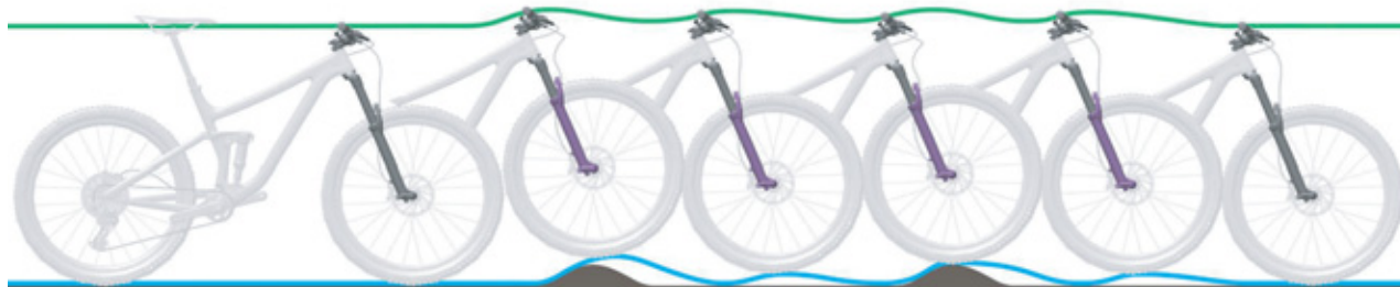
Illustration 211 : Détente trop rapide de la fourche suspendue
