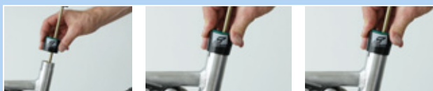
Illustration 181 : Placer l'enveloppe extérieure
