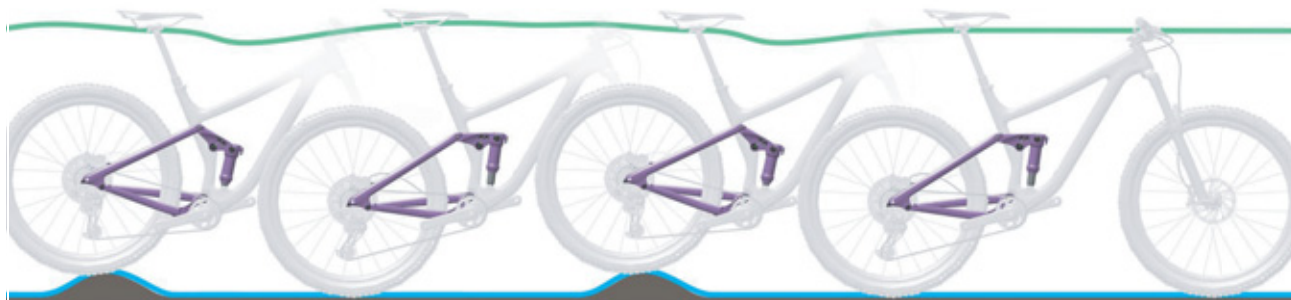
Illustration 19 : Comportement optimal de l'amortisseur arrière
