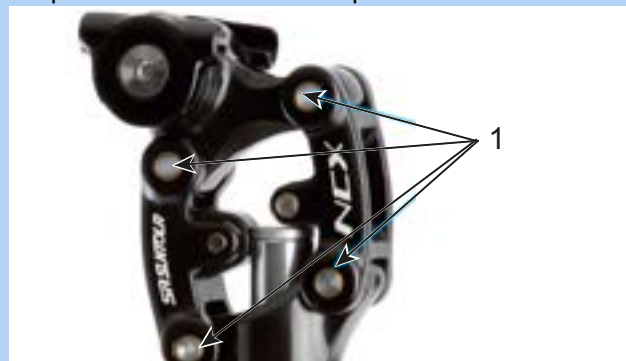
Illustration 149 : Points de lubrification de la tige de selle suspendue SR Suntour
