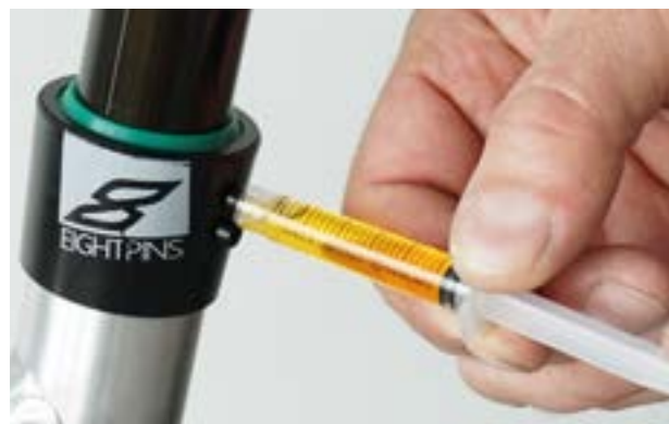
Illustration 135 : Lubrifier un tube de tige de selle
