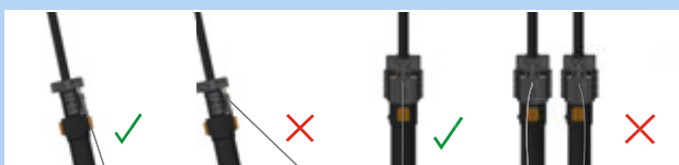
Illustration 177 : Câble Bowden correct et incorrect
