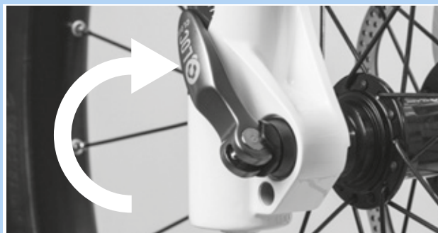
Illustration 75 : Fermer l'attache rapide
