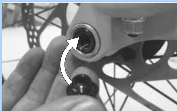
Illustration 64 : Enfoncez le levier d'attache rapide dans l'axe
