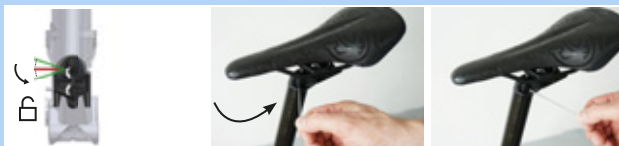
Illustration 150 : Placer le mécanisme de réglage de la hauteur en « position ouverte »
