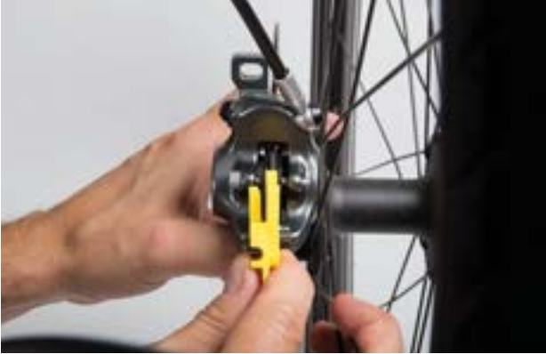
Figura 187: Comprobación de la almohadilla de freno montada con ayuda del seguro de transporte
