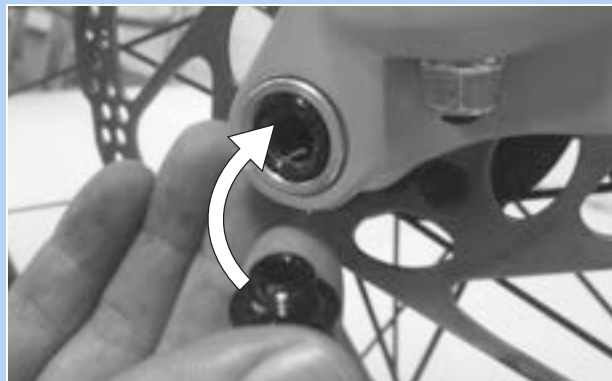
Figura 83: Insertar el tornillo de seguridad
