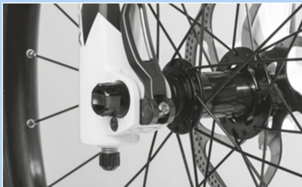
Figura 215: Ajuste de la fuerza de tensado del cierre rápido
