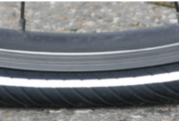
Figura 125: Presión de inflado demasiado baja
