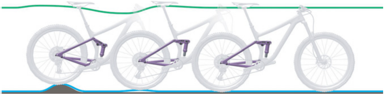
Figura 225: Descompresión demasiado rápida del amortiguador de la horquilla trasera
