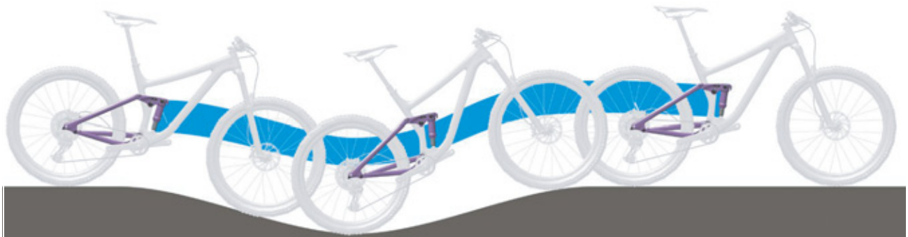
Figura 6: Condición óptima de marcha del amortiguador de la horquilla trasera sobre un terreno accidentado
