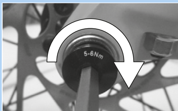
Figura 84: Apriete del tornillo de seguridad
