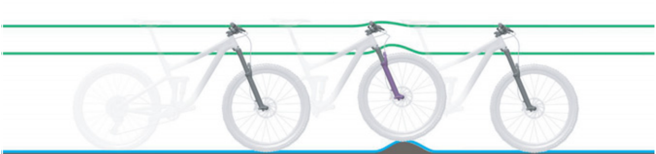
Figura 18: Condición óptima de marcha de la horquilla en caso de irregularidades
