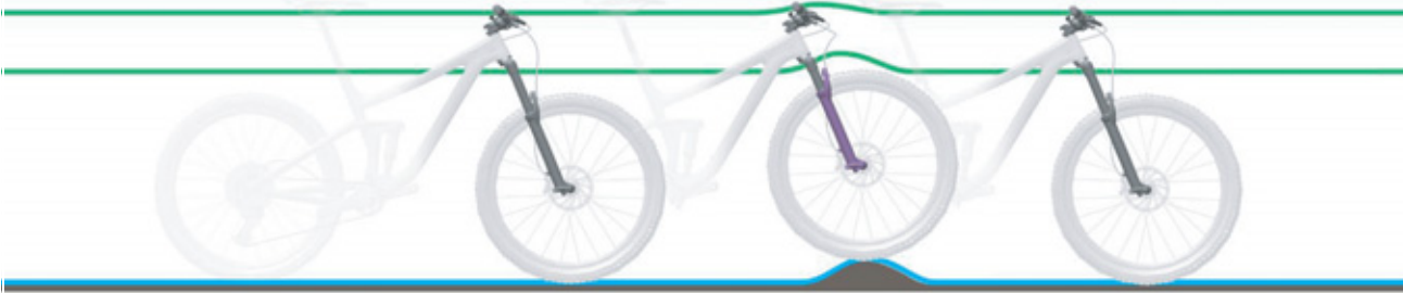
Figura 133: Condición óptima de marcha de la horquilla en caso de irregularidades
