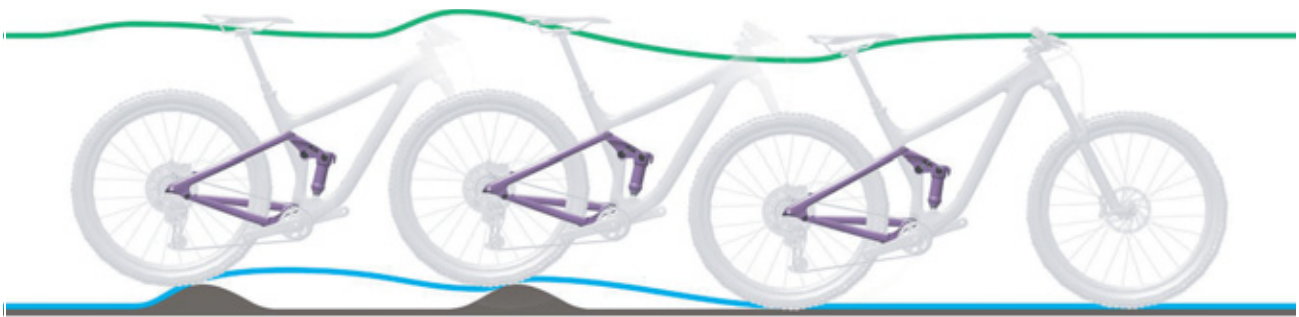
Figura 227: Descompresión demasiado lenta del amortiguador de la horquilla trasera
