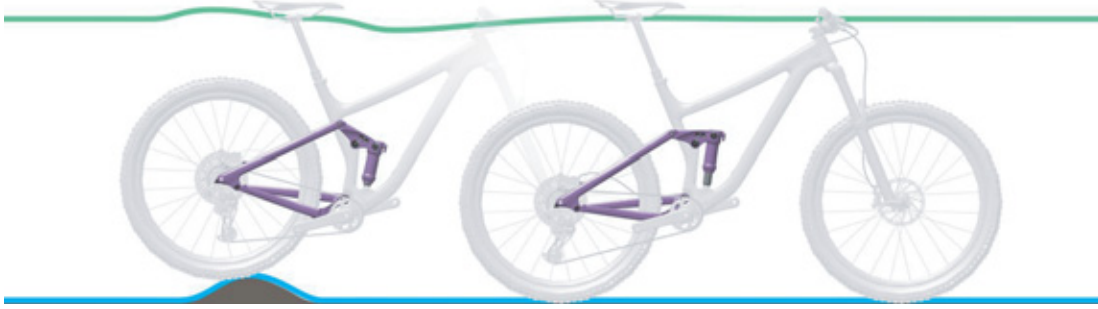
Figura 7: Condición óptima de marcha del amortiguador de la horquilla trasera en caso de irregularidades
