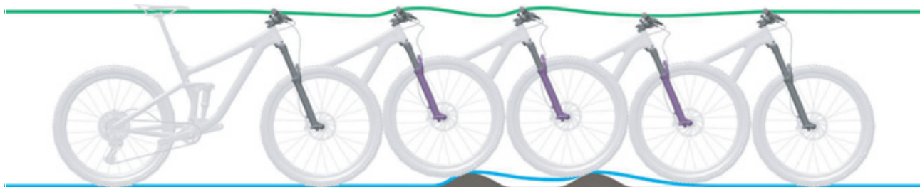
Figura 221: Descompresión demasiado lenta de la horquilla de suspensión
