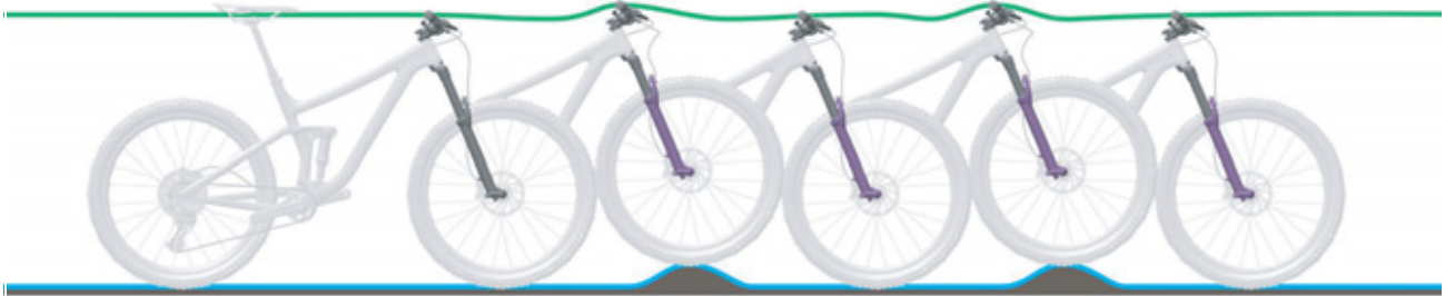
Figura 16: Condición óptima de marcha de la horquilla
