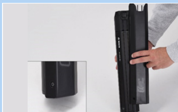
Figura 79: Desplazamiento de la cubierta de la batería sobre la batería
