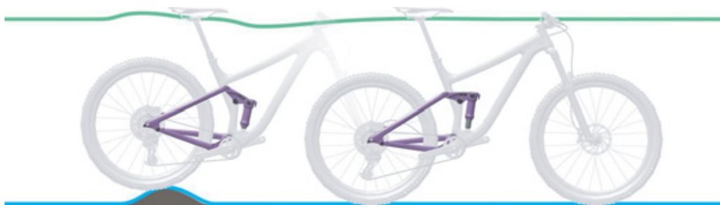
Figura 138: Condición óptima de marcha del amortiguador de la horquilla trasera en caso de irregularidades
