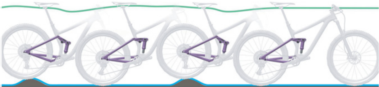
Figura 142: Condición óptima de marcha del amortiguador de la horquilla trasera
