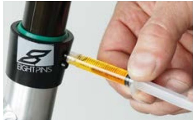
Figura 183: Lubricación de la tija de sillín eightpins
