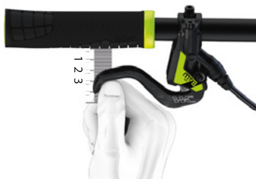
Figura 129: Posicionamiento del freno de mano
