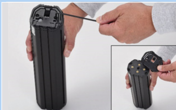
Figura 76: Desmontaje de la interfaz superior
