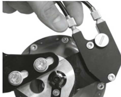
Figura 212: Las versiones de bujes ROHLOFF con activación de cambio externa tienen los dispositivos de ajuste de tensión en la caja de cables que se encuentra en el lado izquierdo
