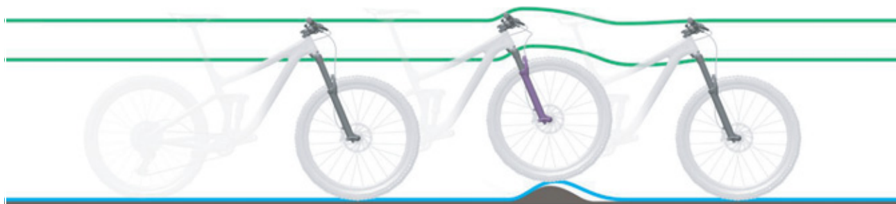
Figura 224: Amortiguación de la horquilla de suspensión demasiado dura en caso de irregularidades
