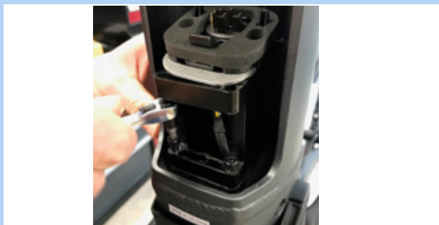
Figura 68: Retirada de los tornillos hexagonales de 4 mm
