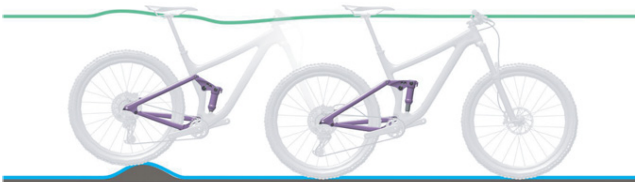
Figura 165: Condición óptima de marcha del amortiguador de la horquilla trasera en caso de irregularidades
